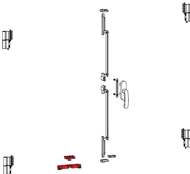
Impiego: Nell'anta affiancata su anta battente, in sostituzione del catenaccio.
