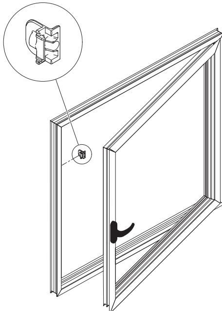
Impiego: Chiusure multiple per infissi a battente, si può montare sia in orizzontale che in verticale.
